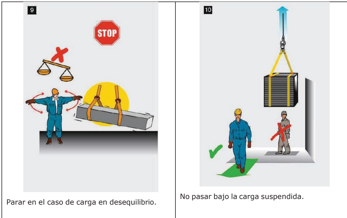
Figura 20: Izado de cargas 3
